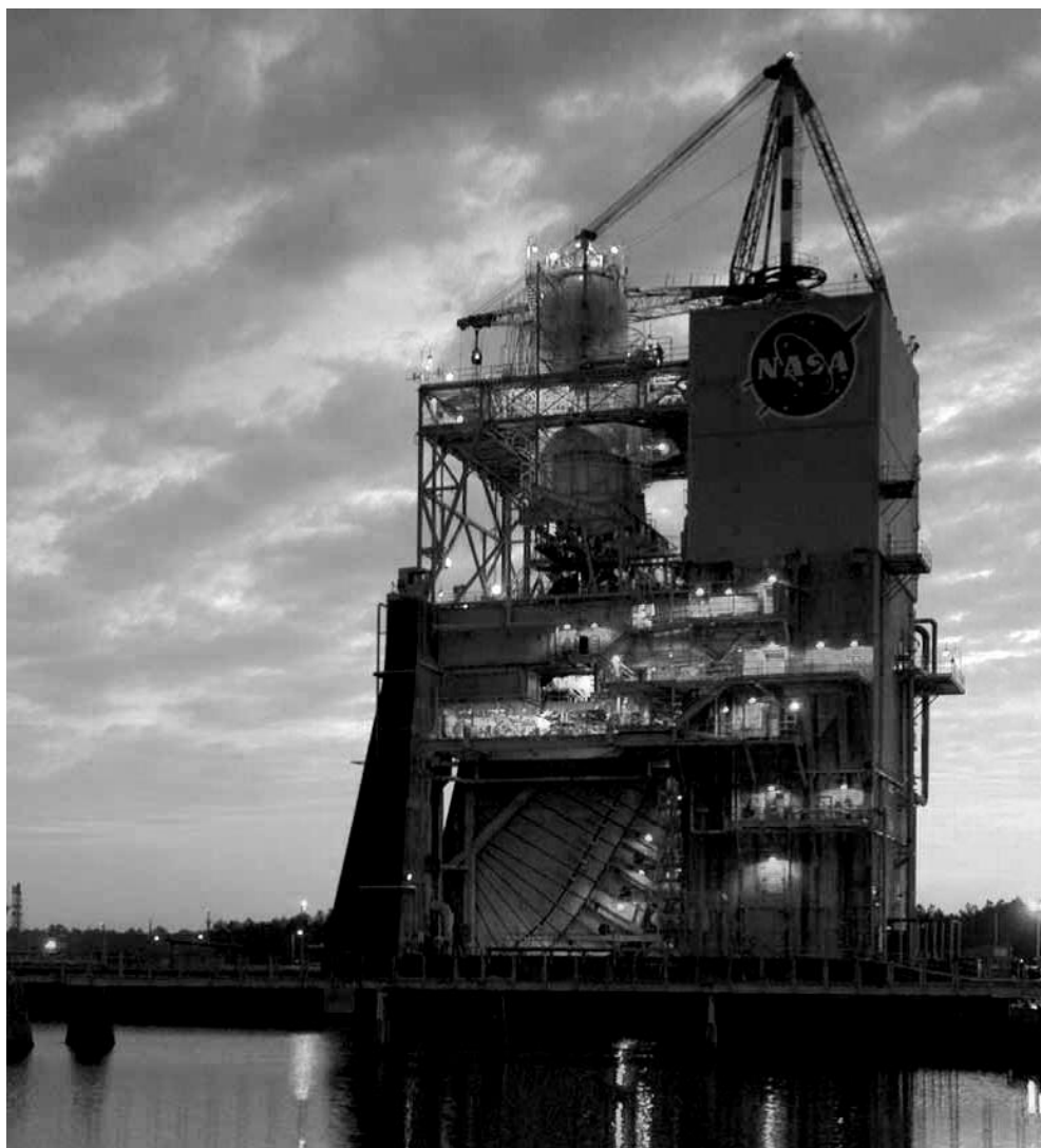
Рис. 2.10. Стенд А-1 для отработки и сертификации полноразмерных двигателей
