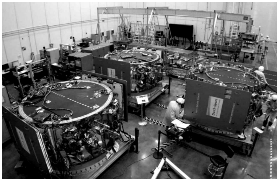
Рис. 2.15. Сборка и проверка модулей грузового корабля Cygnus (компания Orbital Sciences Corporation)
