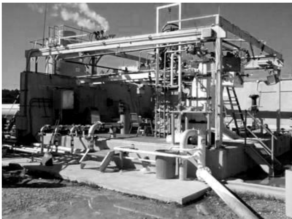
Рис. 2.9. Стенд Е-2 для испытаний агрегатов и узлов ракетных двигателей
