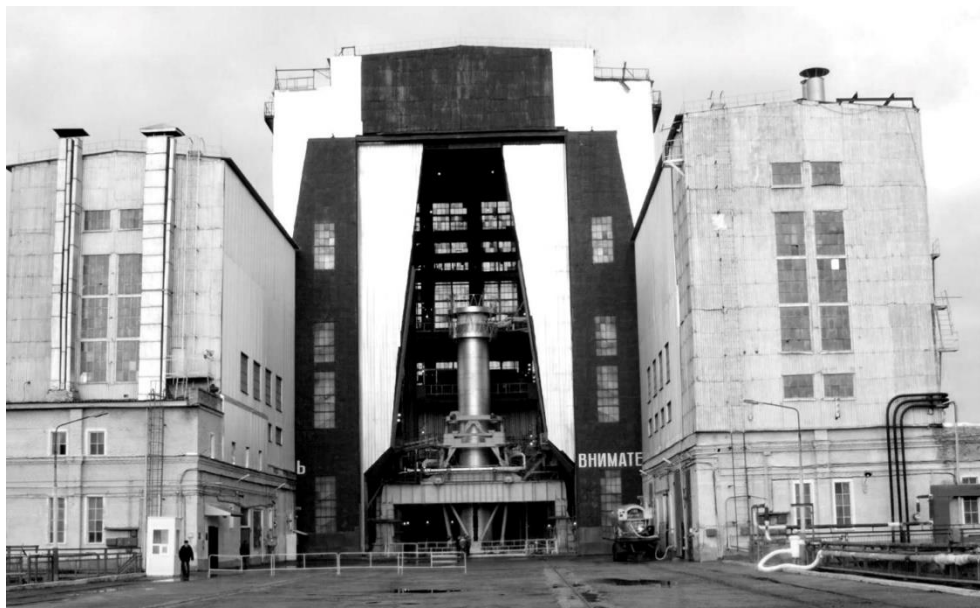
Рис. 2.31. Универсальный ракетный модуль УРМ-1 ракеты-носителя «Ангара» на испытательном стенде ИС-102 ФКП «НИЦКП»
