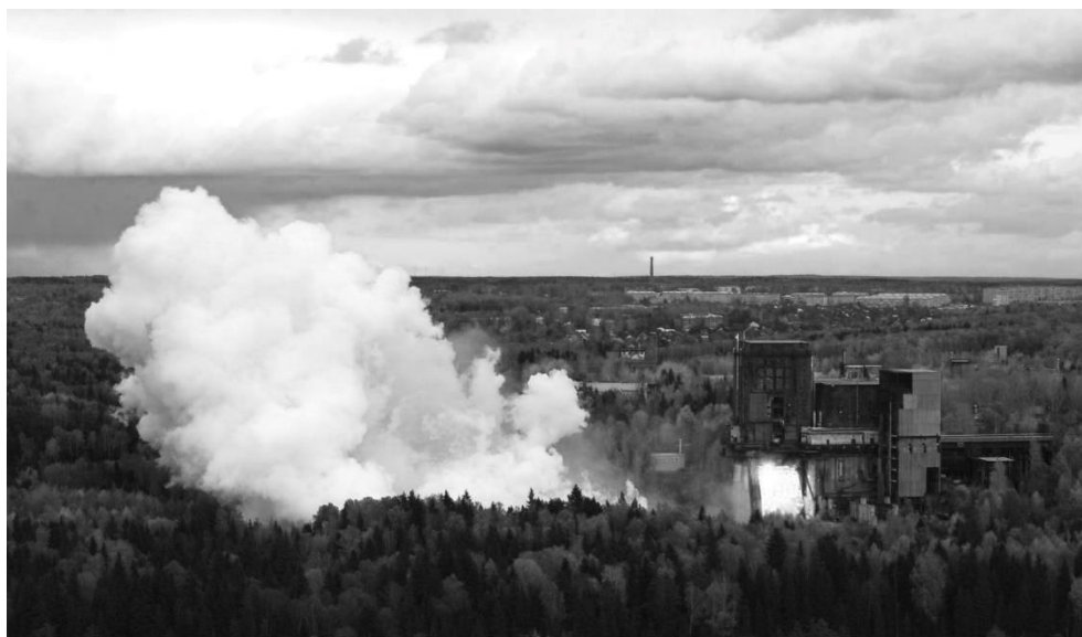
Рис. 2. 32. Огневые стендовые испытания модуля УРМ-1 ракеты-носителя «Ангара» на испытательном стенде ИС-102 ФКП «НИЦ РКП»
