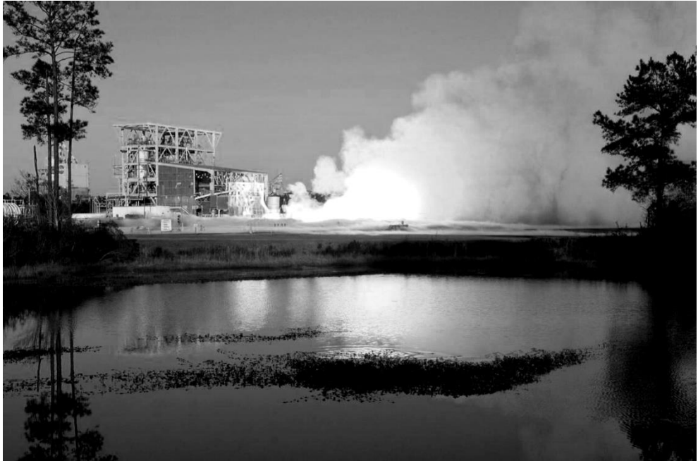
Рис. 2.12. Испытания ракетного двигателя РН Antares в Центре Стенниса
